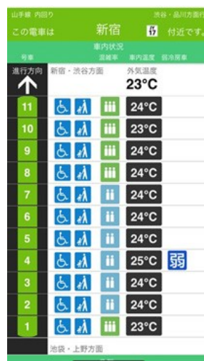
Figura 17: O aplicativo JR East mostra em tempo real a situação em cada vagão: nível de congestionamento, temperatura e instalações para PRM (passageiros com mobilidade reduzida)
