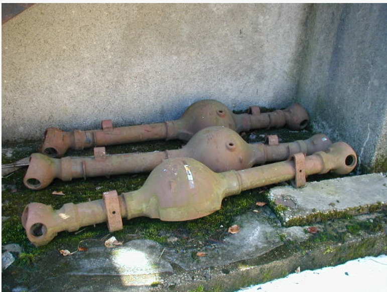
Vehicle parts made of steel containing cobalt 60 (Súčiastky vozidiel vyrobené z ocele obsahujúcej Kobalt 60)
