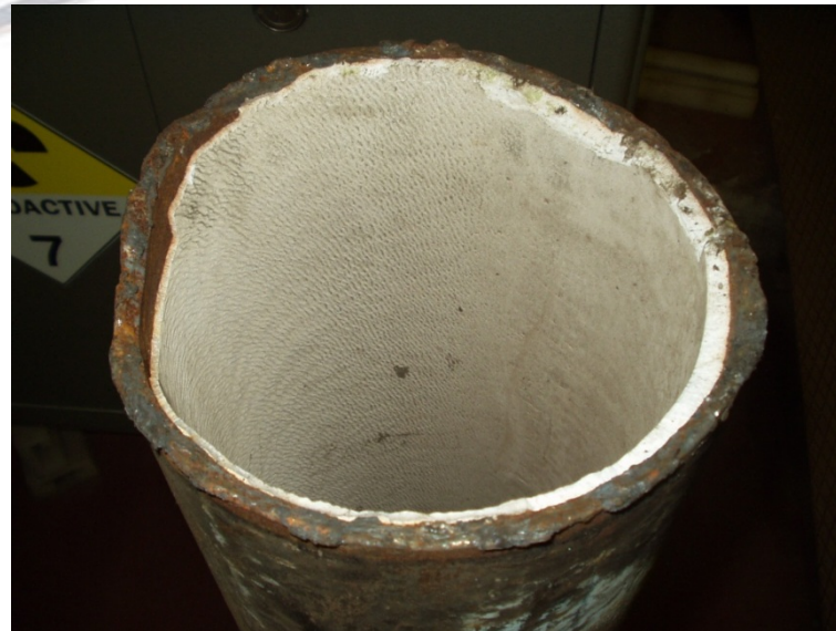
Inkrust containing natural radionuclides – from equipment used in deep drillings in Azerbaijan (Inkrust obsahujúci prírodné rádionuklidy – z náradia používaného pri hĺbkových vrtoch v Azerbajdžane)
