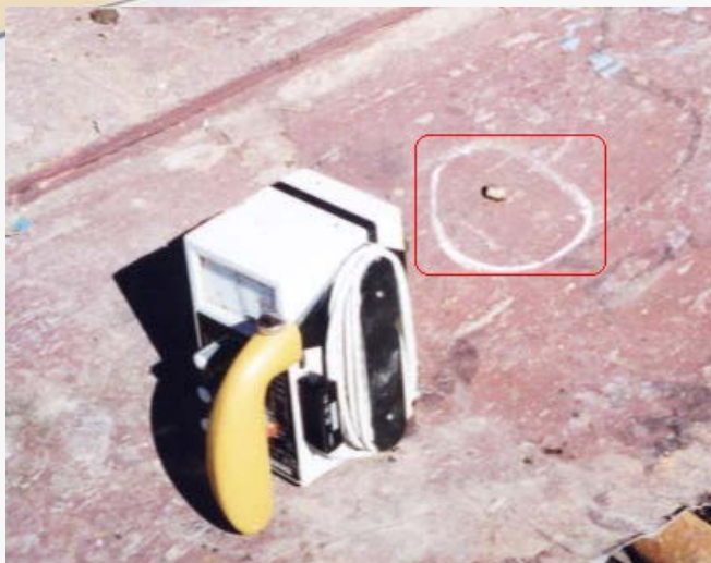
Closed source Cesium 137 - roller 3x5 mm (uzavretý žiarič Céziom 137 – valček 3x5 mm)
