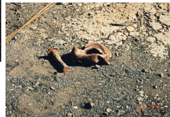
Package containing Cobalt 60 (púzdro obsahujúce Kobalt 60)
