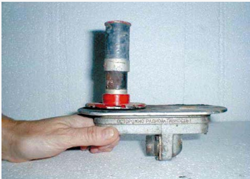
Ice-meter from military aircraft made in Soviet union containing Strontium 90 (merač námrazy z vojenských lietadiel sovietskej výroby obsahujúci Stroncium 90)
